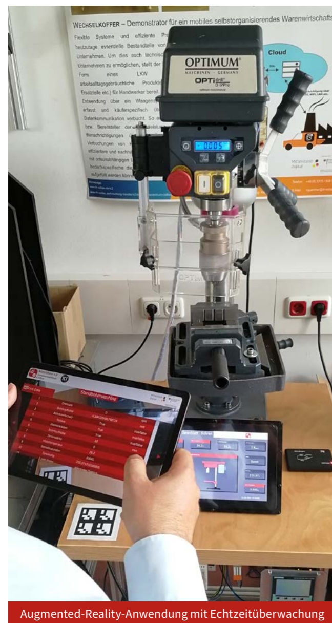
Abbildung 2: Digitalisierung als Grundlage für die Anwendung eines digitalen Zwillings und einer erweiterten Realitätsanwendung (Augmented Reality) für mobile Endgeräte
